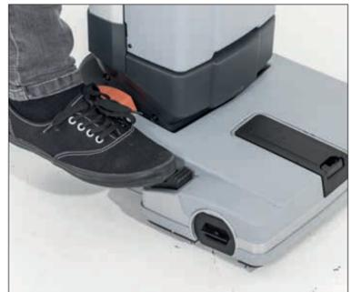
10. Um starke Verschmutzungen einzuweichen heben Sie die Saugleiste durch Betätigung des Pedals an. Senken Sie anschließend die Saugleiste ab, um die Reinigungslösung wieder aufzunehmen.
