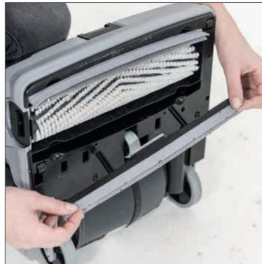
2. Entnehmen Sie die Saugleisten und entfernen ggf. Schmutz. Sollten die Saugleisten beschädigt sein müssen sie ersetzt werden.
