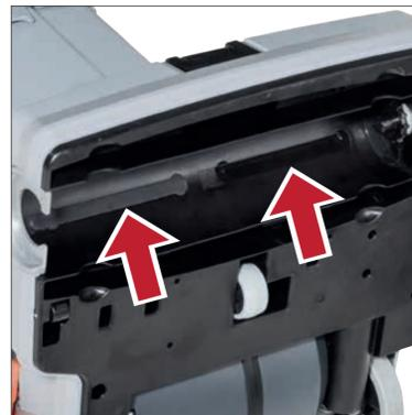
3. Bei verstopften Frischwasserverteilern ist eine Entnahme und Reinigung notwendig.
